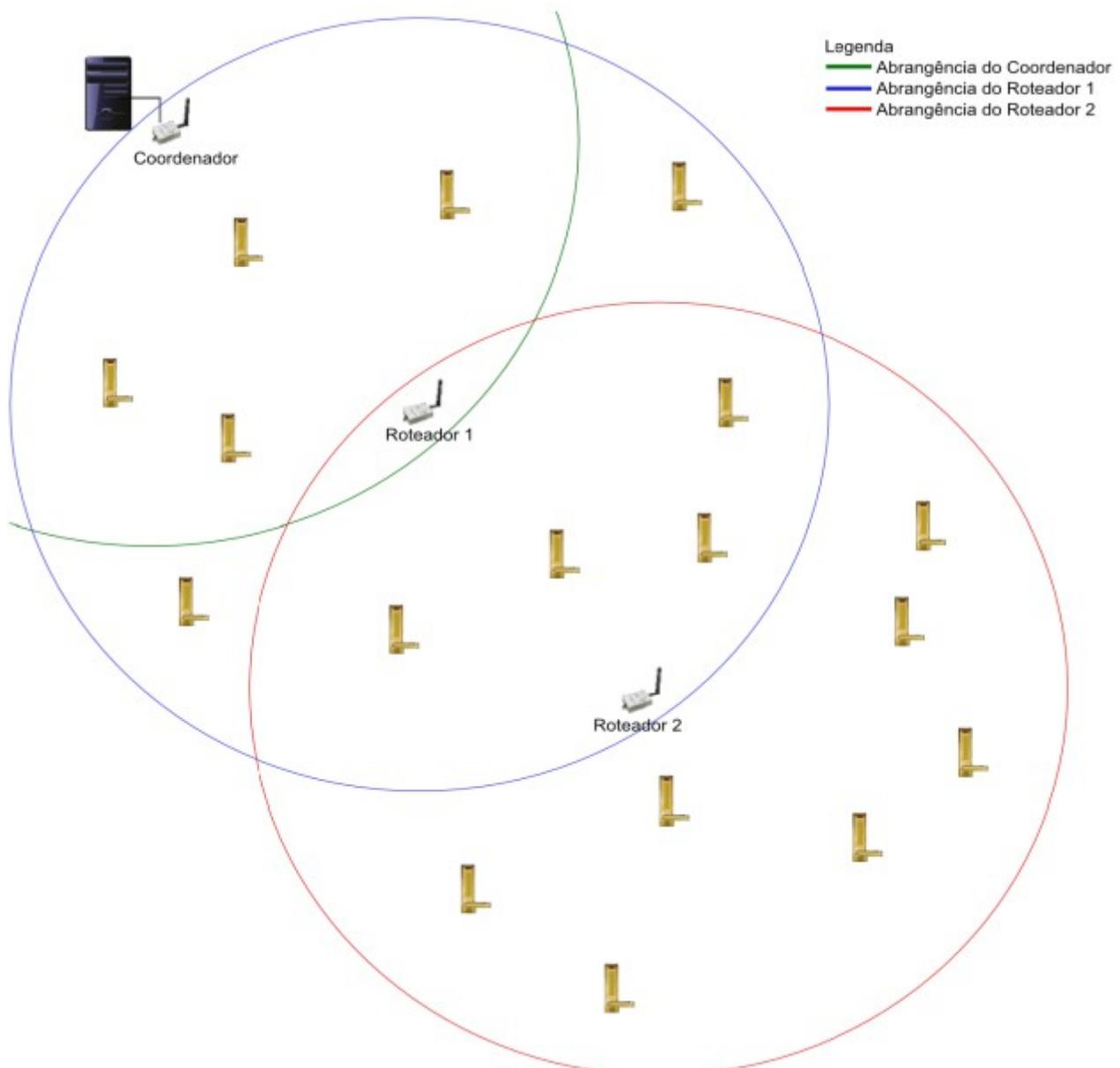
*Ilustração 15: Rede ZigBee com Repetidor ZigLock*
